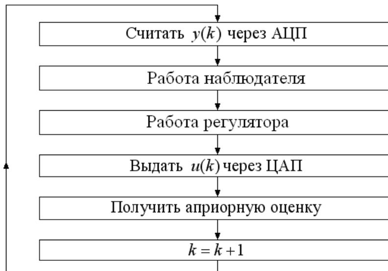
Рис. 2. Схема алгоритма работы замкнутой системы с регулятором состояния и наблюдателем
